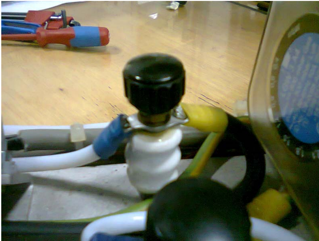
Figura 6: O cabo elétrico da lâmpada é ligado diretamente no borne do cabeçote IST
