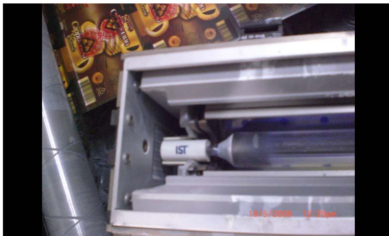
Figura 3: Lâmpada conectada no suporte cerâmico IST
