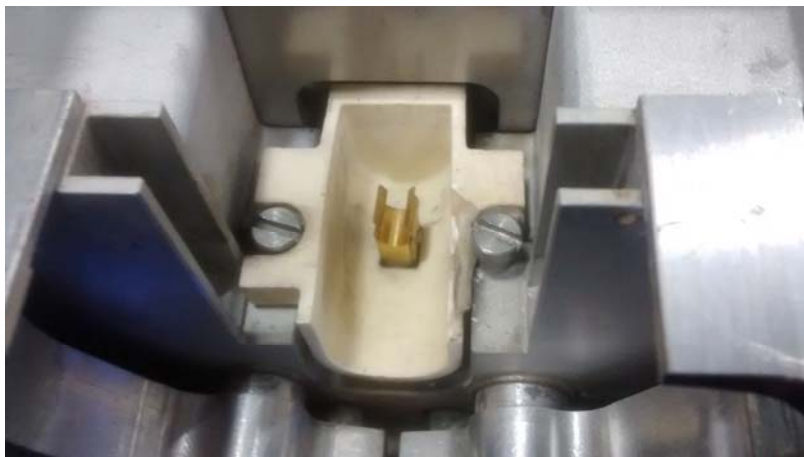
Figura 1 : Suporte cerâmico IST já danificado durante o uso.
